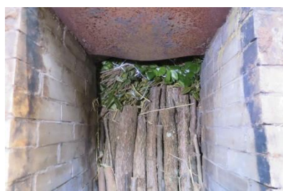
入口まで原木、藁、バイタを積み上げています。
