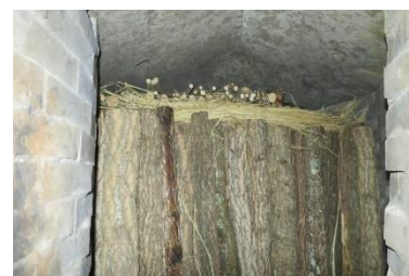
原木の上に藁を敷きその上にバイタ（燃料・細い丸太）をすき間なく詰めています。
